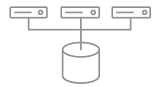
FIGURE 1. SHARED-DISK ARCHITECTURE (CLUSTER TYPE SHOWN)
