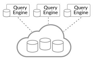
FIGURE 4. CLOUD HUB-AND-SPOKE ARCHITECTURE
