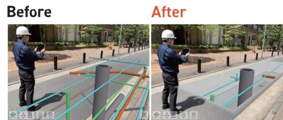
現実空間にARで仮想の穴を空け、その穴の中に3Dモデルの埋設部を配置することができます。
