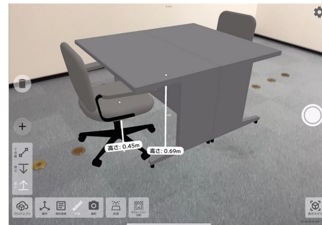
地面より上に表示した3Dモデルの任意の1点を選択すると、iPadが認識した床面から選択箇所までの距離を表示します。
