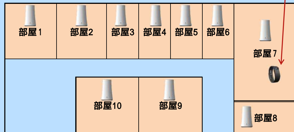
目的とするBLEデバイスを「部屋7」にあるBLEルーターが最も強く認識
